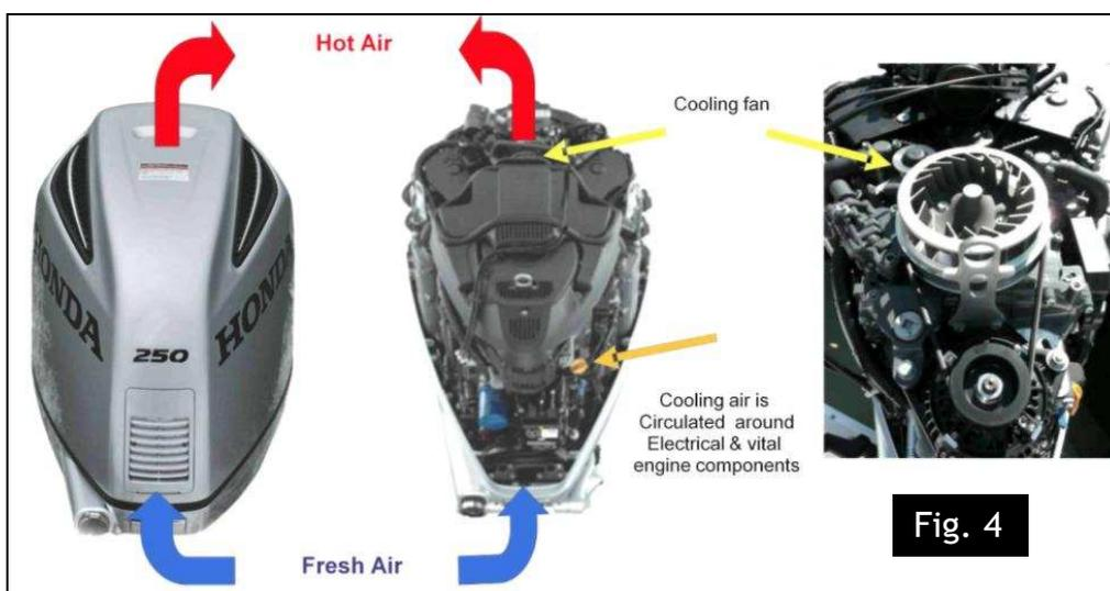
Monté sur la face supérieure, le ventilateur entraîné par le vilebrequin aspire l'air frais à travers les événements avant, le diffuse dans tout le compartiment moteur et l'expulse par le sommet du capot (Fig. 4).
